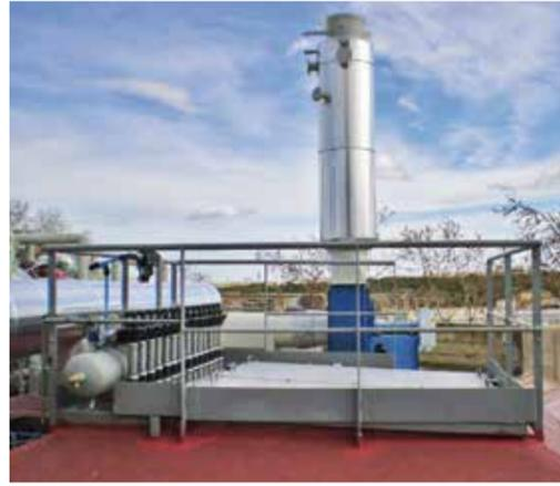
Los hornos crematorios Kalfrisa se complementan con sistemas de depuración de gases para la filtración, neutralización de sustancias ácidas y captación de metales pesados, dioxinas y furanos
